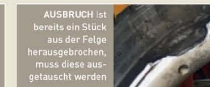
**AUSBRUCH** Ist bereits ein Stück aus der Felge herausgebrochen, muss diese ausgetauscht werden
