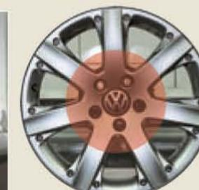
Im roten Bereich ist keine Felgenaufbereitung möglich (weiter als 50 mm vom Rand entfernt)
